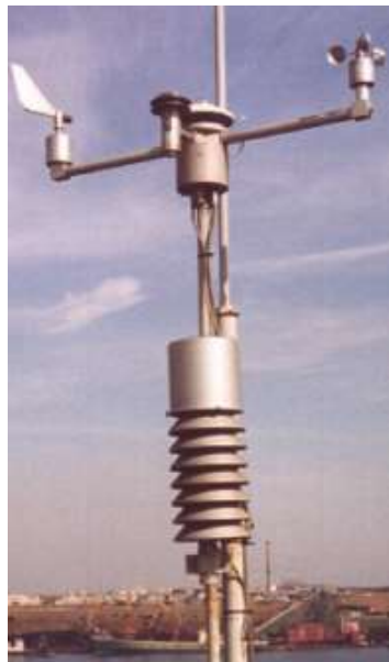
Рис. 3. Автоматическая метеорологическая станция, осуществляющая сбор и передачу метеорологических данных.
